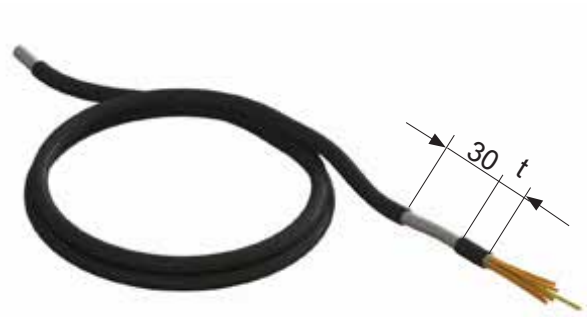
Kuva 25 Kuori EMC-kaapeli 30 mm:n matkalta ennen kuin liität sen kytkentärimaan. Mitta "t" vastaa suunnitteen kiinnikkeen ja kaapelipuristimen etäisyyttä.
