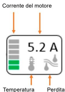
Figura 1-4: Finestra informativa sulla pompa in assenza di allarmi o condizioni di guasto
