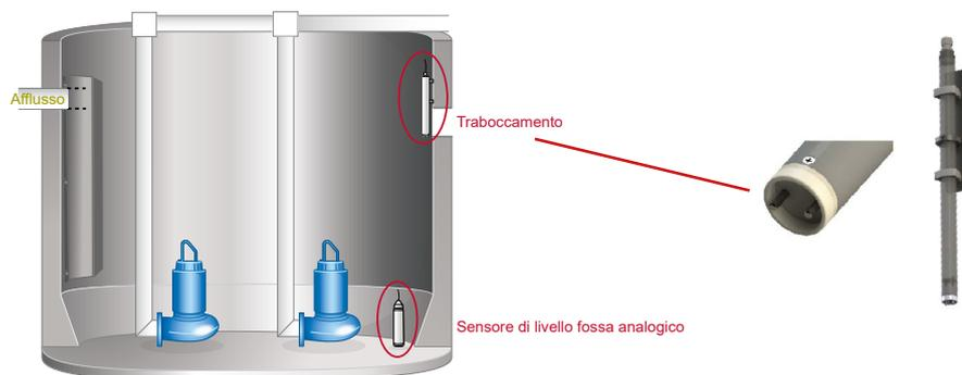
Figure 3-7: Illustrazione di una fossa per pompe con sensore di troppopieno
