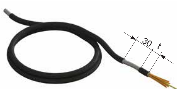
25. ábra Távolítsa el az EMC kábel szigetelését 30 mm-es hosszúságban a csatlakoztatás előtt. A „t” méret megfelel a rögzítőbilincs és a kábelkapocs közötti hozzátétőleges távolságnak
