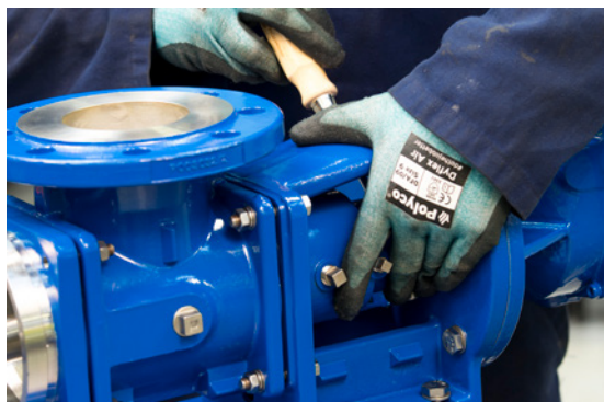
1. När stator och rotor är borttagna når man drivenheten
