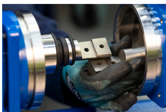
6. Lossa den hydrauliska rotorn från drivaxeln
