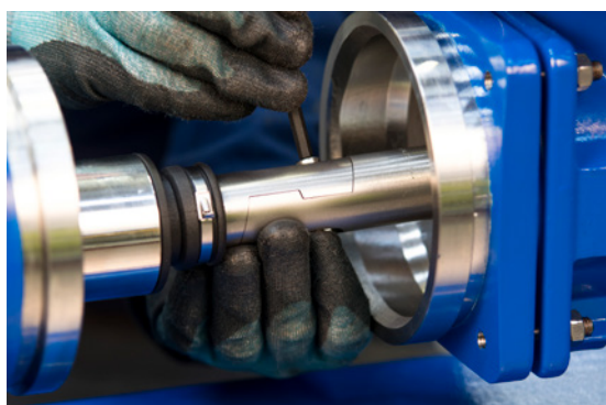
5. Den delade kopplingen hålls ihop av skruvar
